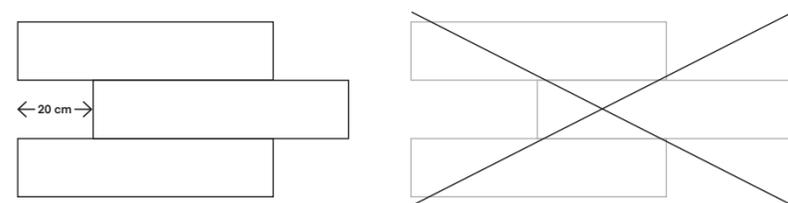
Si raccomanda di posare i materiali sfalsati di 20 cm al massimo, mai a metà della loro lunghezza / It is strongly recommended to install the materials in a staggered pattern of a maximum of 20 cm, never at half way its length / Il est conseillé de poser les matériaux en décalé de 20 cm au maximum, jamais à la moitié de leur longueur / Es wird empfohlen, die Materialien um höchstens 20 cm versetzt zu verlegen und nie in der Mitte ihrer Länge
