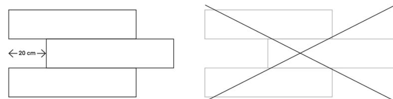
Si raccomanda di posare i materiali sfalsati di 20 cm al massimo, mai a metà della loro lunghezza / It is strongly recommended to install the materials in a staggered pattern of a maximum of 20 cm, never at half way its length / Il est conseillé de poser les matériaux en décalé de 20 cm au maximum, jamais à la moitié de leur longueur / Es wird empfohlen, die Materialien um höchstens 20 cm versetzt zu verlegen und nie in der Mitte ihrer Länge
